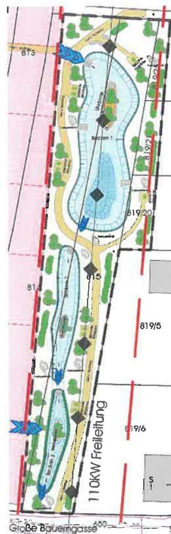
Entwurf zur Umsetzung einer Parkanlage mit Retentionsraum innerhalb der Schutzzone der Freileitung auf Grundlage alter Planungen [VMB AG, 11/2018]
