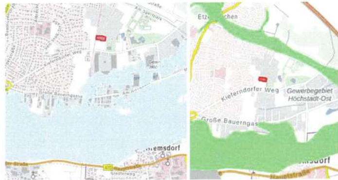
HQextrem (li.) und wassersensible Bereiche (re.) im Bereich des Plangebietes [Quelle: BayernAtlas]
